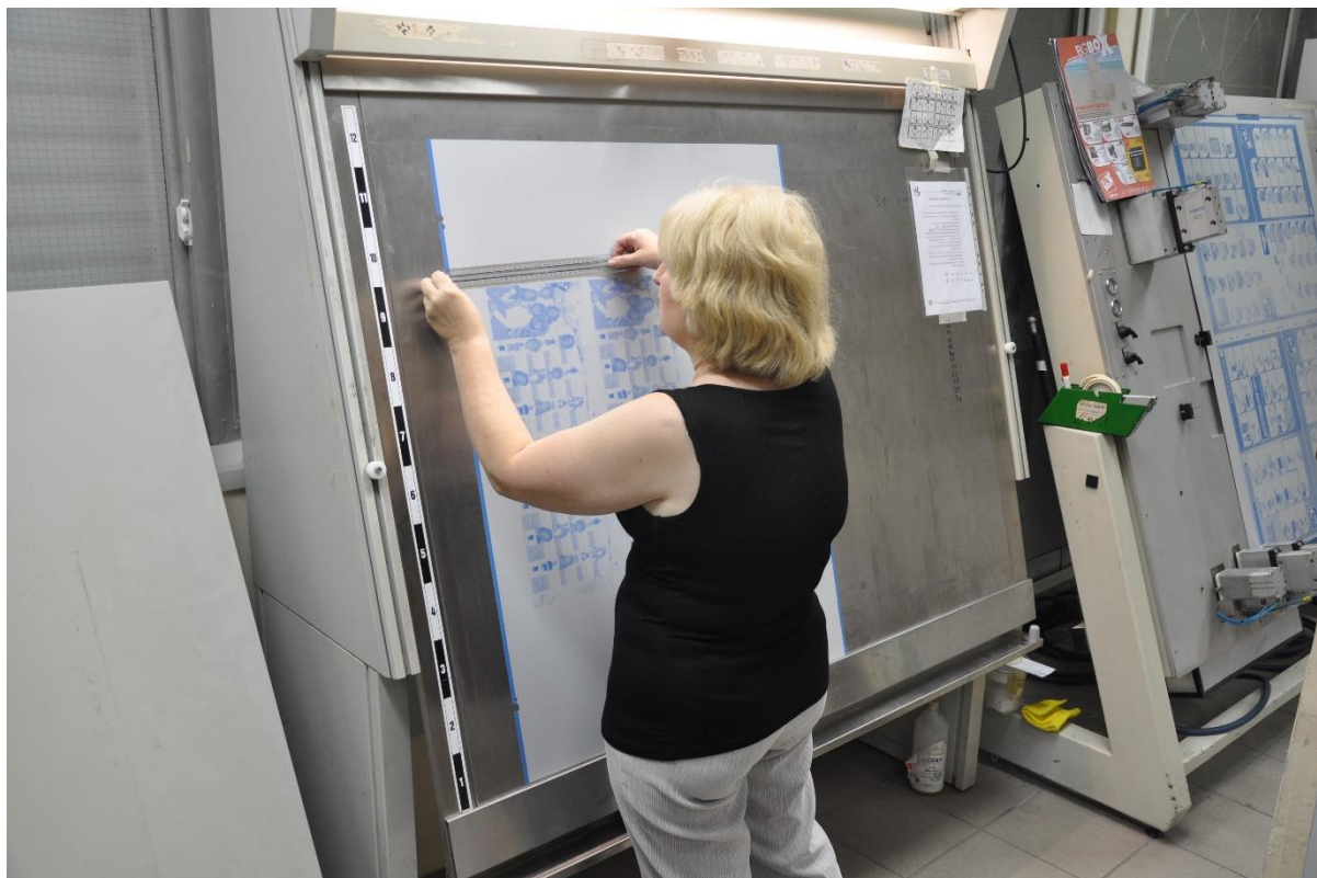
בדיקה של לוח הדפסה עשוי יריעת אלומיניום שאותו כרכו בהמשך סביב גליל הדפסה
